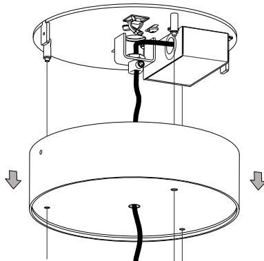
포함된 설치 고리 (A 위치)를 사용하여 더 쉽게 설치하십시오.
